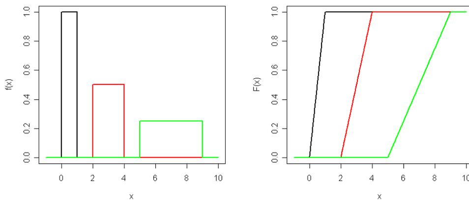
Figure 5: Dichte und Verteilungsfunktion der Gleichverteilung mit  $a = 0, b = 1$  (schwarz),  $a = 2, b = 4$  (rot) und  $a = 5, b = 9$  (grün).
