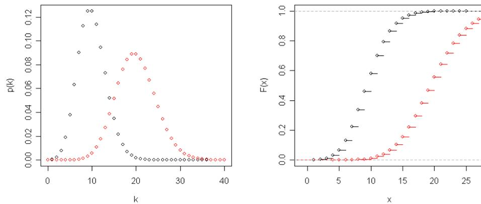
Figure 3: Zähldichte und Verteilungsfunktion der Poissonverteilung mit  $\lambda = 10$  (schwarz) und  $\lambda = 20$  (rot).
