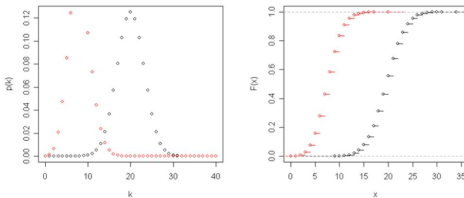
Figure 2: Zähl-dichte und Verteilungsfunktion der Binomialverteilung mit  $n = 40$ ,  $p = 0.5$  (schwarz) und  $p = 0.2$  (rot).
