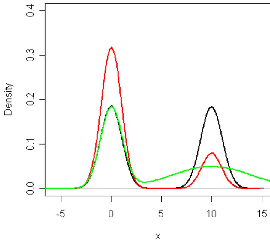
Figure 7: Dichte und Verteilungsfunktion von Mischungen von Normalverteilungen mit  $\mu_1 = 0, \sigma_1 = 1, \mu_2 = 10, \sigma_2 = 1, \alpha_1 = \alpha_2 = 0.5$  (schwarz),  $\mu_2 = 10, \sigma_2 = 1, \alpha_1 = 0.8, \alpha_2 = 0.2$  (rot) und  $\mu_2 = 10, \sigma_2 = 4, \alpha_1 = \alpha_2 = 0.5$  (grün).
