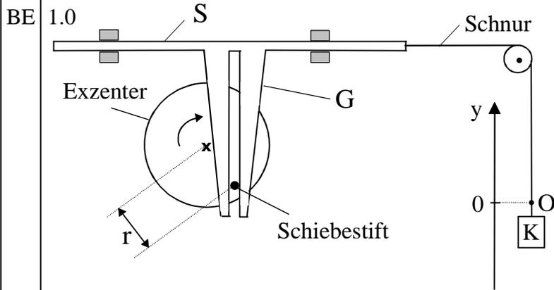
Ein Exzenter, dessen Schiebestift auf einem Kreis mit dem Radius  $r = 8,0 \text{ mm}$  umläuft, bewegt über ein Geschiebe  $G$  eine horizontal geführte Stange  $S$ . An der Stange  $S$  ist eine Schnur befestigt, die über eine Rolle läuft und an deren anderem Ende ein Körper  $K$  mit der Masse  $m = 200 \text{ g}$  hängt.
