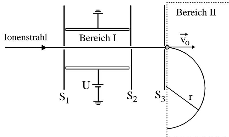
Einfach positiv geladene Ionen mit verschiedenen Geschwindigkeiten treten durch die Öffnung in der Blende  $S_1$  in den Bereich I ein. In diesem Bereich I herrschen ein homogenes Magnetfeld mit der Flussdichte  $\vec{B}$  und zusätzlich das homogene elektrische Feld eines Plattenkondensators mit der Feldstärke  $\vec{E}$ . Die beiden Felder sind zeitlich konstant.
